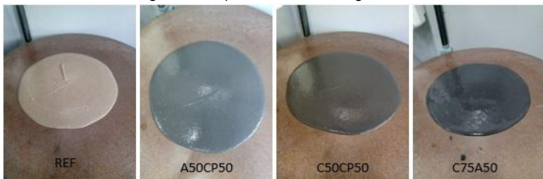
Imagem 2 - Espalhamento das argamassas
