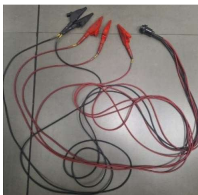
Figura 23 - Cabos para medição de tensão
