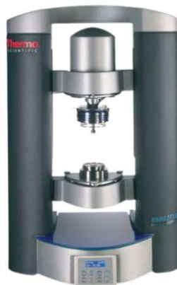
Figura 5 - Reômetro Haake Mars 40 utilizado para análise dos parâmetros reológicos das pastas cimentícias
