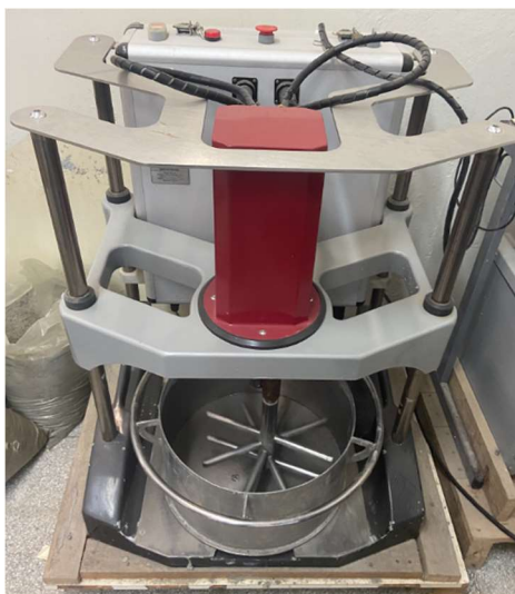
Figura 6 - Reômetro Pheso utilizado para mistura e análise dos parâmetros reológicos das amostras de concreto de alto desempenho
