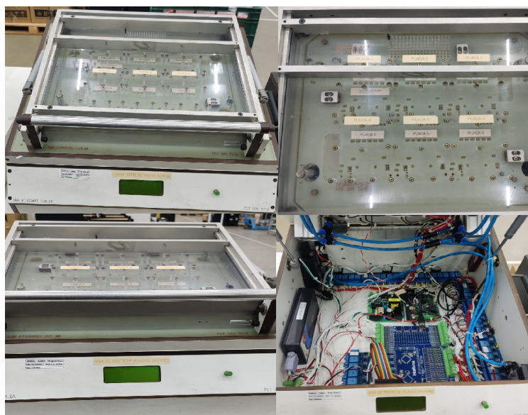
Figura 11 - Jiga de teste (linha de produção)
