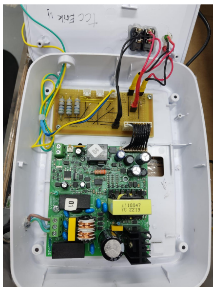
Figura 41 - Case de iluminação aberta
