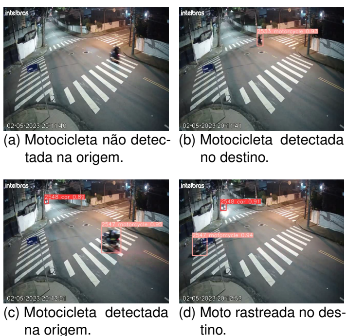
Figura 46 – Rastreamento motocicleta em dois movimentos distintos.
