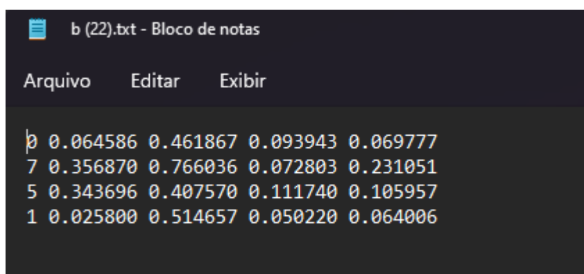
Figura 24 – Exemplo dos labels retornados pela plataforma Makesense. Cada linha é um objeto diferente e a ordem das colunas (separadas por espaço) são: classe, posição x, posição y, largura e altura.
