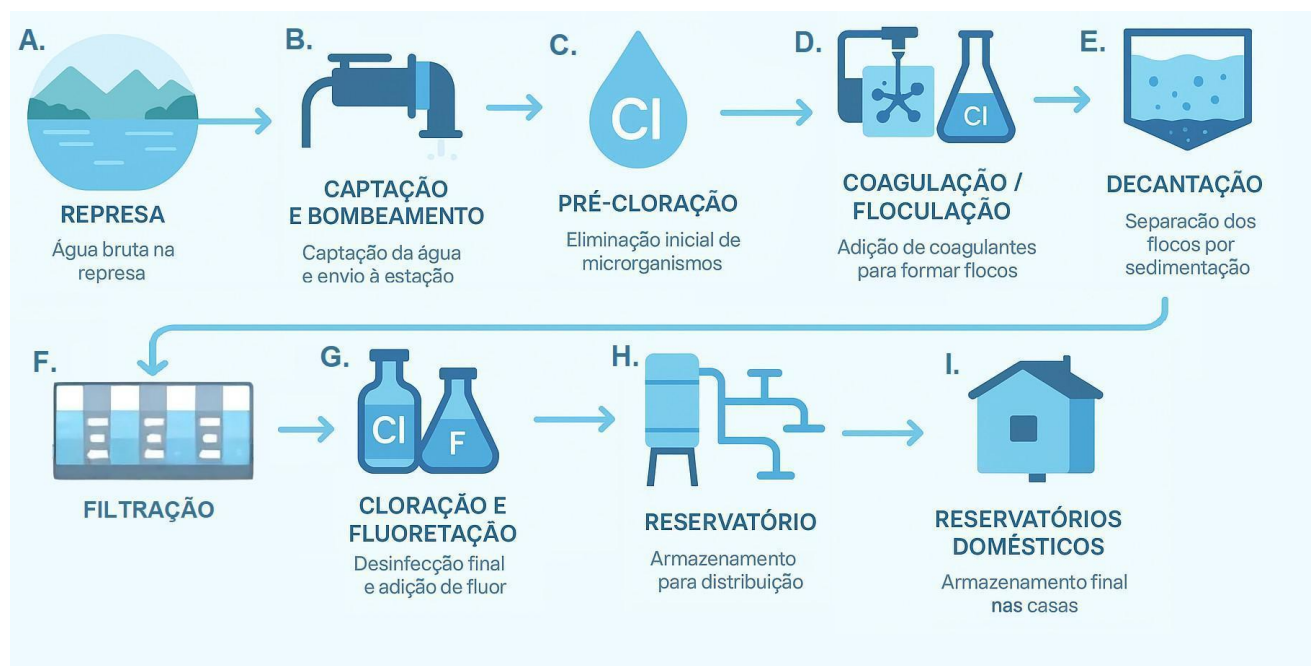
Figura 1: Etapas do tratamento de água convencional. (adaptado, Santos, et al, 2019)
