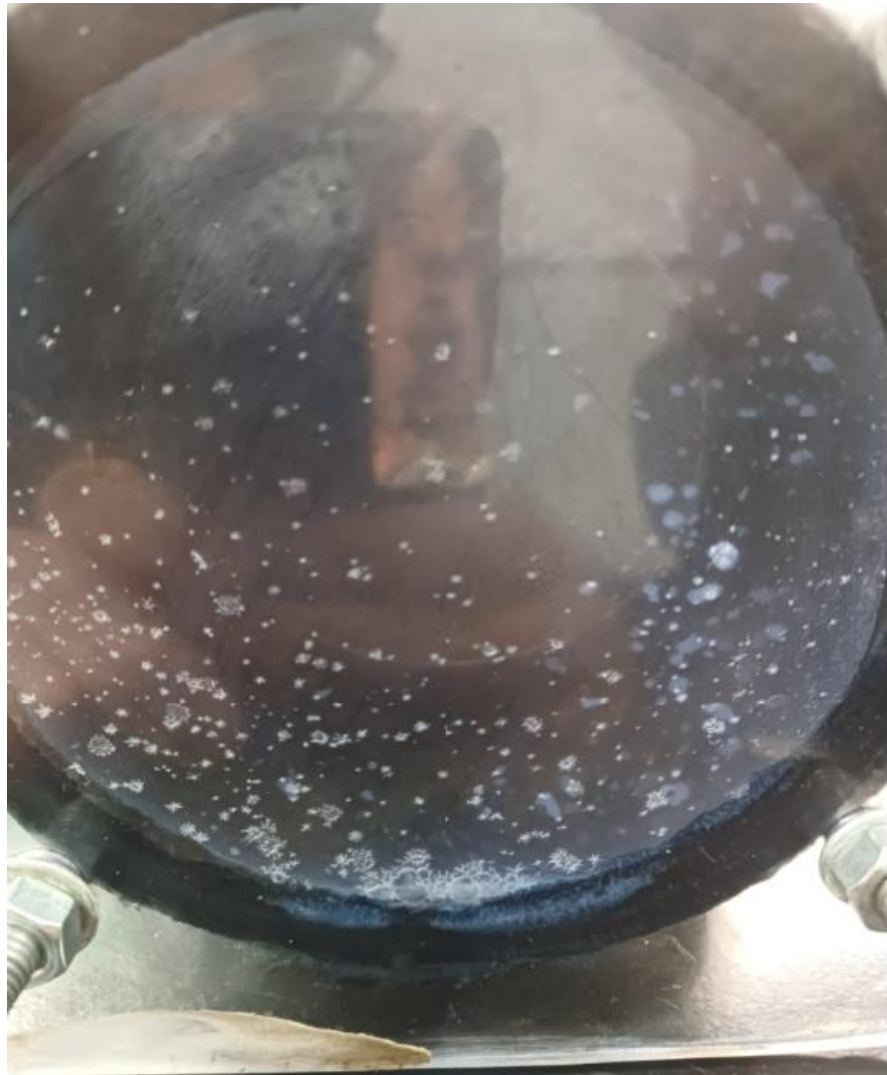
Figura 3.14 - Policarbonato após contatos com Formiato de Metila
