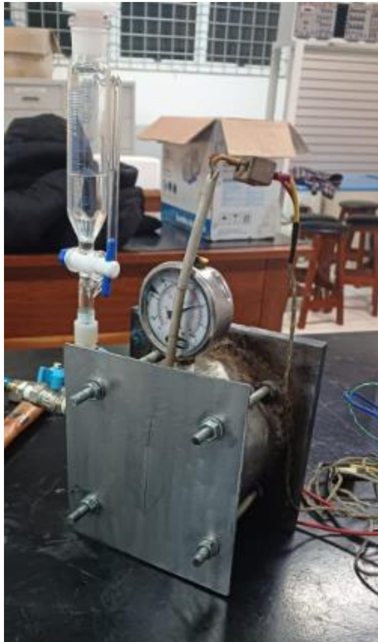
Figura 3.16 – Câmara montada com tampa de aço
