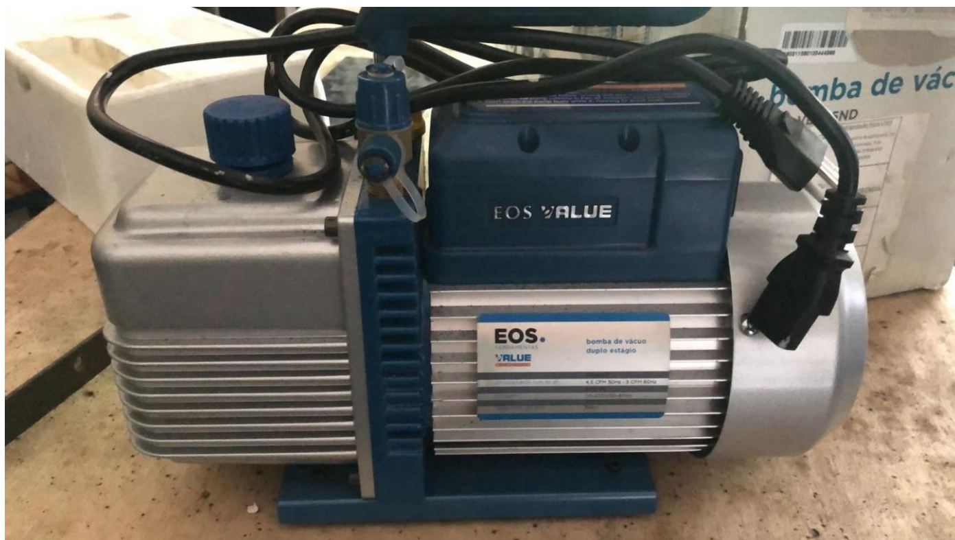
Figura 3.12 - Bomba de vácuo utilizada
