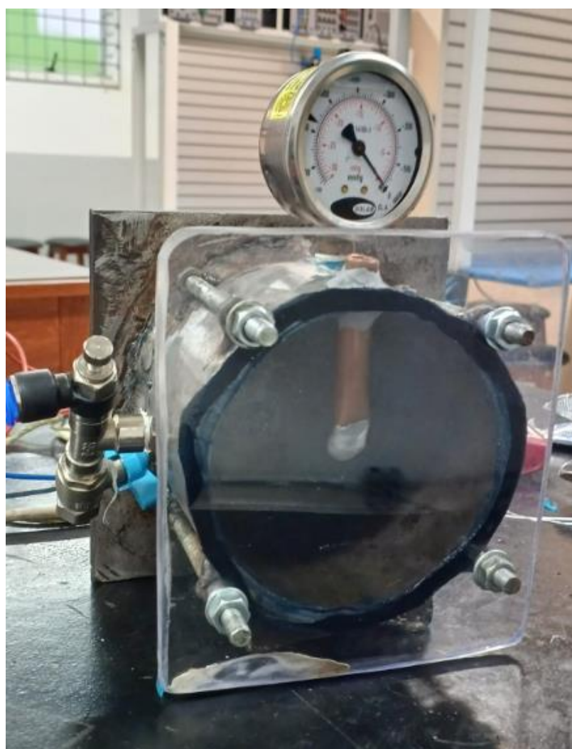
Figura 3.132 – Câmara de teste confeccionada
