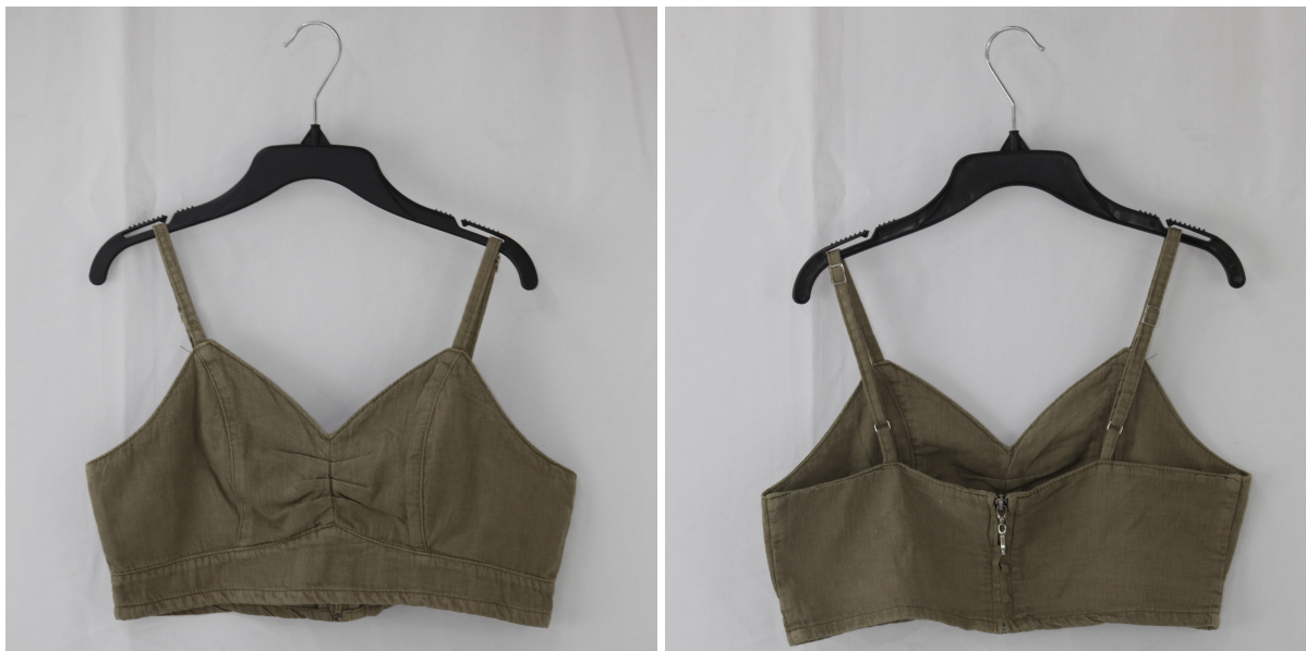
Figura 8 - Fotos da peça do vestuário tingida com corante casca de cebola fixado com sulfato de ferro.
