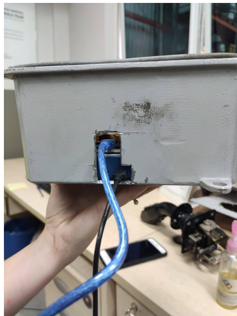
(b) Caixa de passagem com corte lateral para conexão dos cabos.
