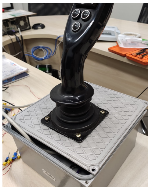
(d) Protótipo final do hardware para acoplamento do joystick , placa de aquisição de dados e conexões.
