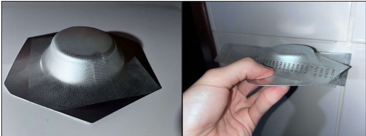
Figura 18 – (a) Chapa de Alumínio Marcada Quimicamente com Círculos de 1 mm; (b) Exemplo de Medição por Visioplaticidade
