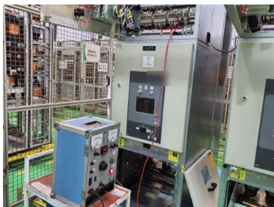
Fig. 7. Painel sendo submetido ao ensaio de tensão suportável na baía de testes
