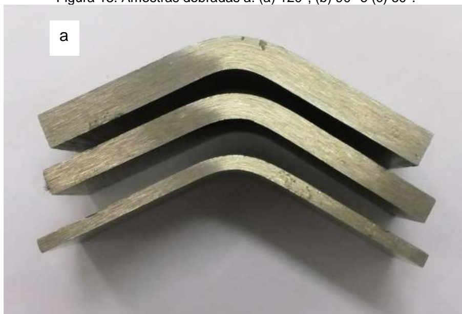
Figura 13: Amostras dobradas a: (a) 120°, (b) 90° e (c) 60°.
