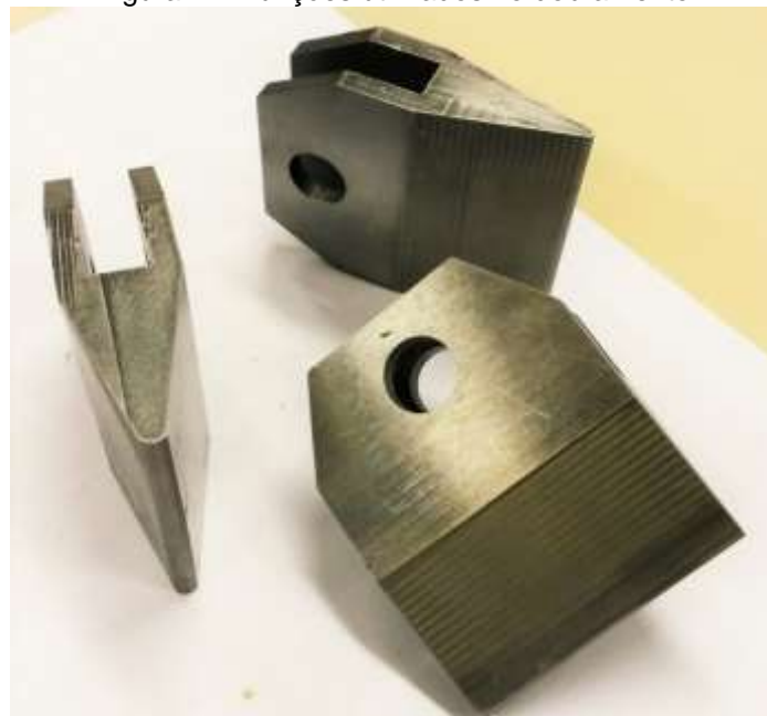
Figura 11: Punções utilizados no dobramento
