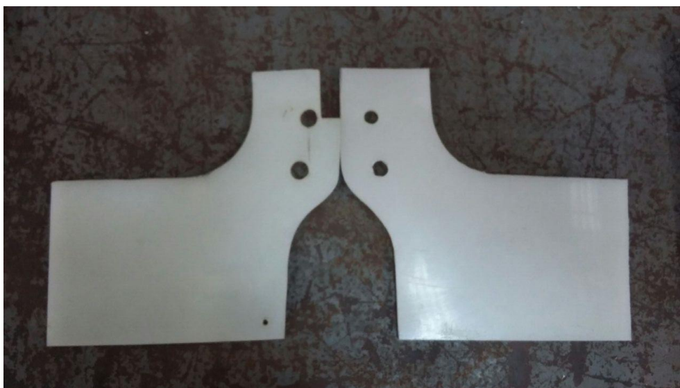
Figura 25- Anterior x Novo puxador do cilindro da esteira superior
