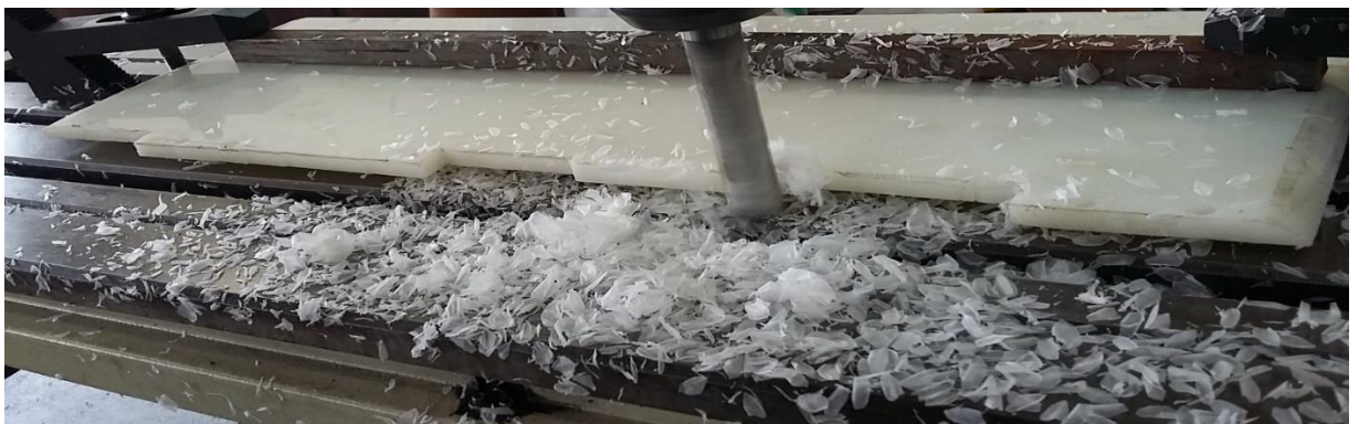
Figura 22- Faceamento da placa de suporte da esteira grande inferior
