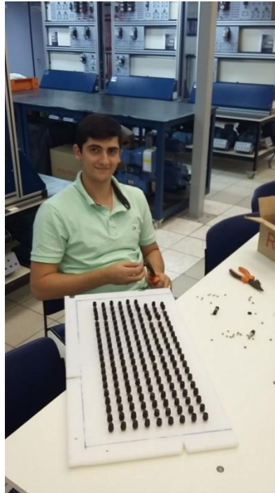
Figura 36- Construção da placa de bornes
