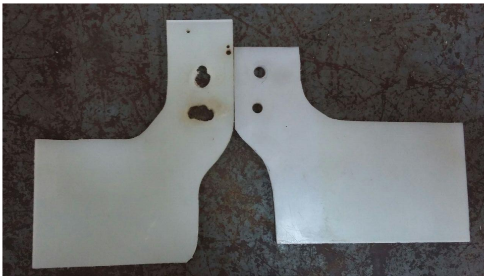
Figura 24- Anterior x Novo puxador do cilindro do elevador
