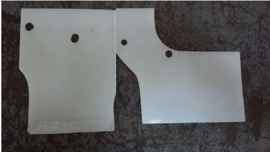
Figura 26- Anterior x Novo puxador do cilindro da esteira superior
