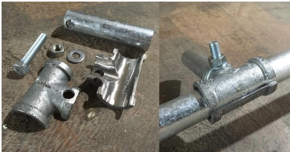
Figura 21 – Eletrodutos, conexão em “T” e parafusos utilizados na estrutura
