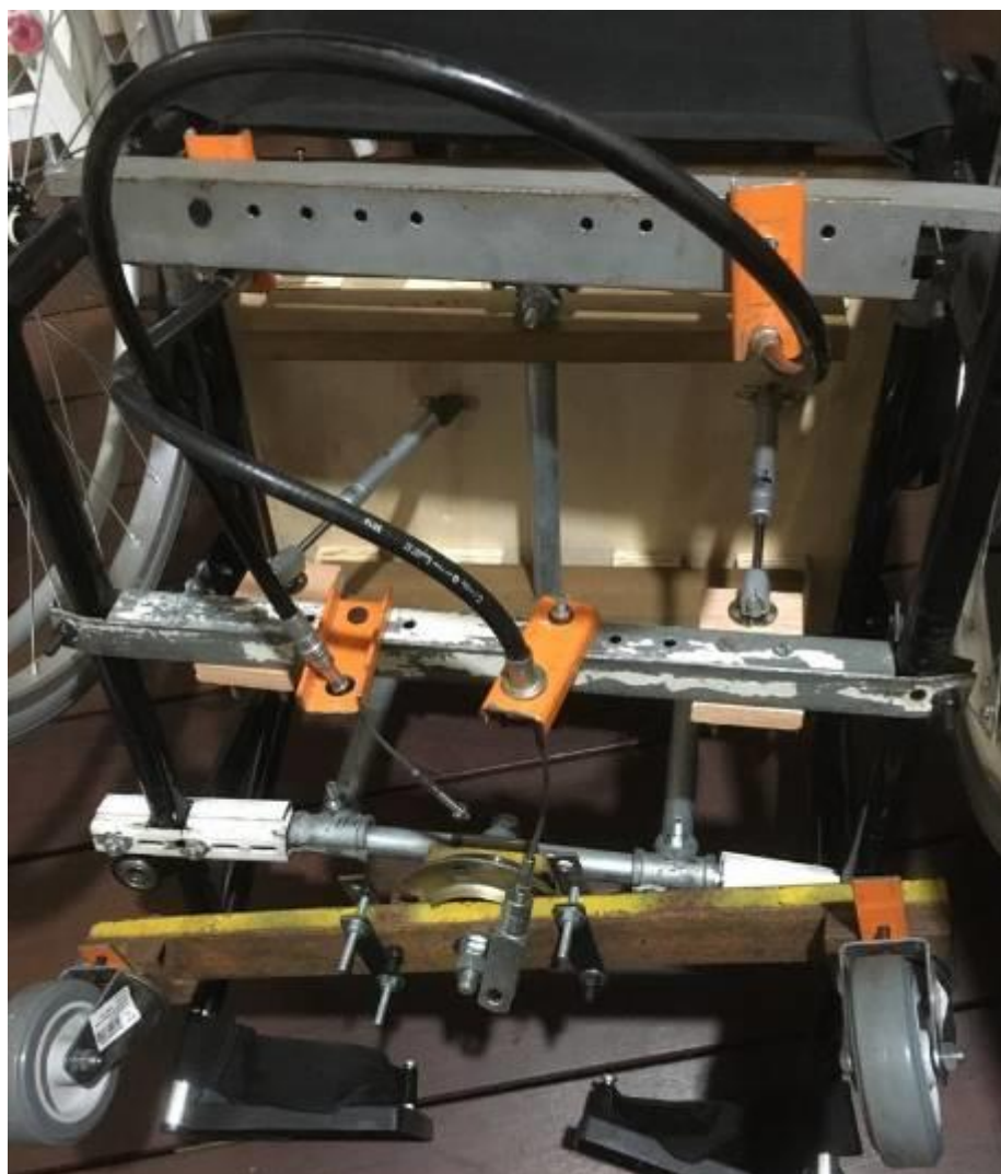
Figura 25 – Instalação dos cabos push pull
