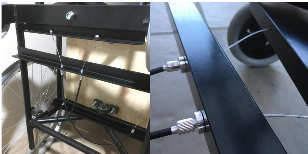
Figura 33 – Instalação dos cabos, conduites e parafusos reguladores de bicicleta
