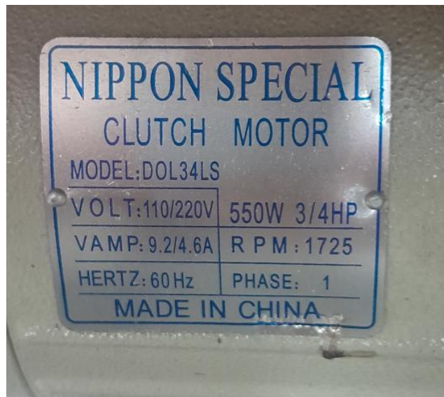
Fig.4. Placa do Motor tipo clutch
