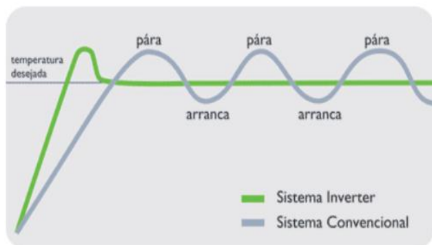
Fig.2. Comparação entre sistema Inverter e convencional. Retirado de [8].
