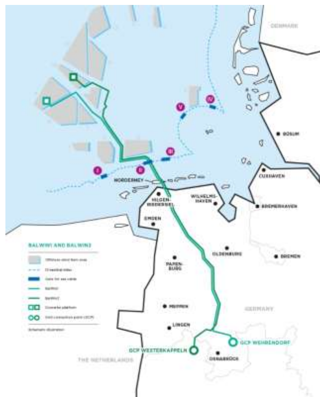
Figura 15 – Futuros sistemas HVDC offshore BalWin1 e BalWin2
