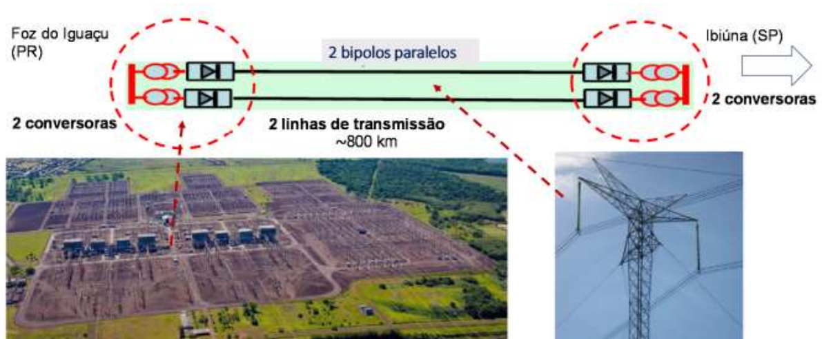
Figura 9 – Esquemático do sistema de transmissão de Itaipu
