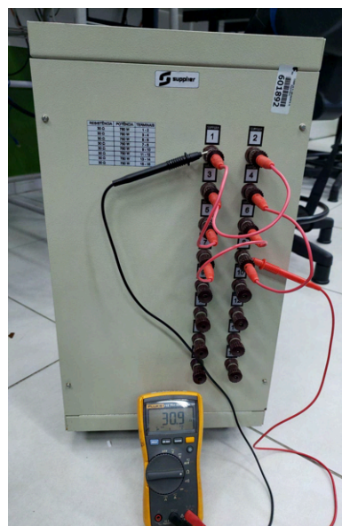
Figura 41 - Carga resistiva referente ao primeiro teste
