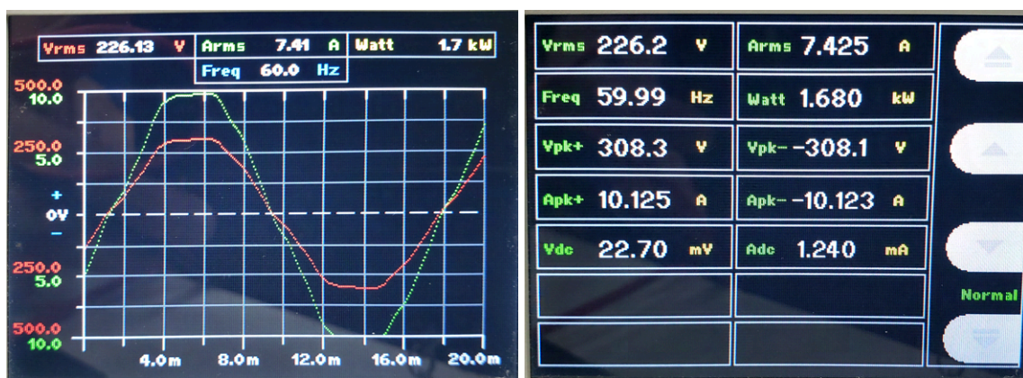
Figura 42 - Medidas realizadas no teste com carga de 30 \Omega
