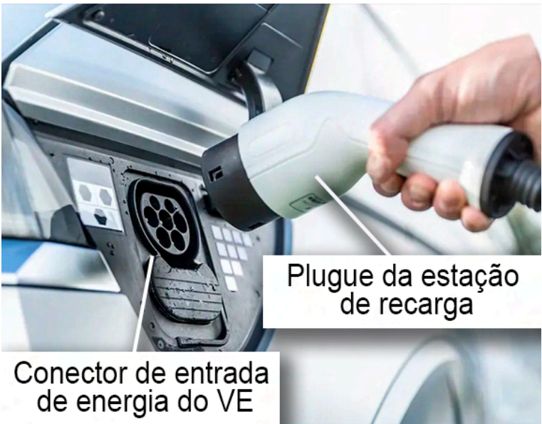
Figura 9 – Sistema de conexão de um veículo elétrico
