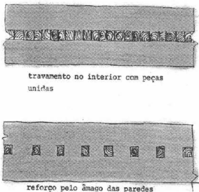
Figura 18: Paredes com reforços internos.
