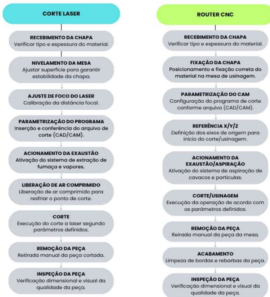
Figura 3 – fluxograma do processo de corte a laser e router CNC
