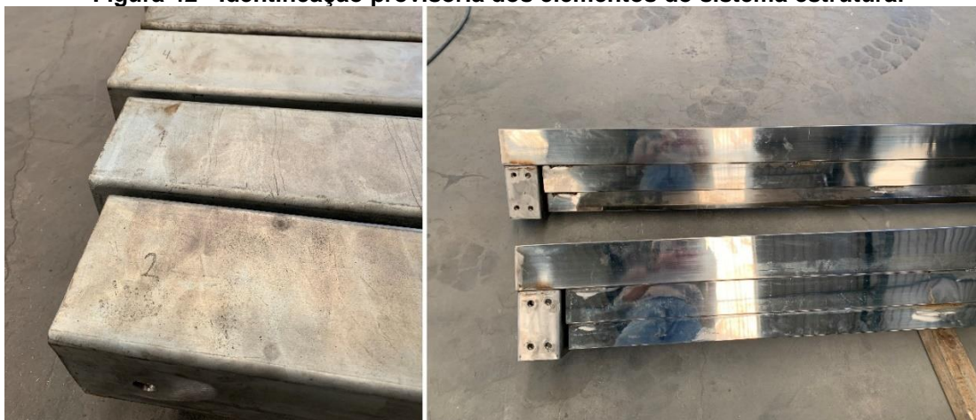
Figura 42 - Identificação provisória dos elementos do sistema estrutural
