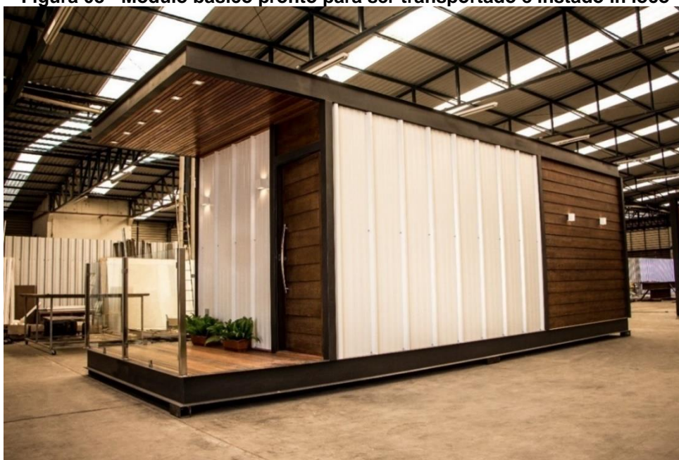
Figura 08 - Módulo básico pronto para ser transportado e instalado in loco
