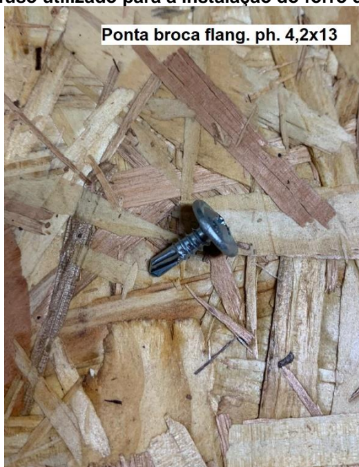
Figura 47 - Parafuso utilizado para a instalação do forro de gesso modular
