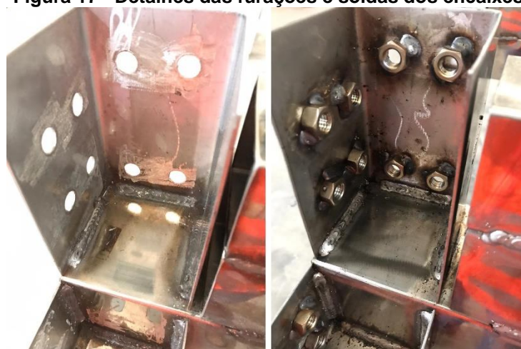
Figura 17 - Detalhes das furações e soldas dos encaixes
