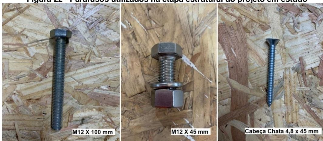
Figura 22 - Parafusos utilizados na etapa estrutural do projeto em estudo
