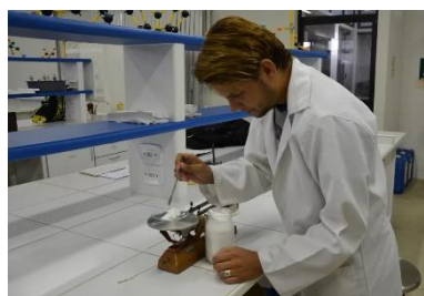
Figura 19: Balança de alta precisão adaptada para cegos
