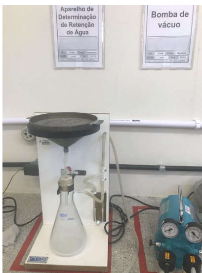
Figura 14 - Funil de Buchner modificado com bomba de vácuo
