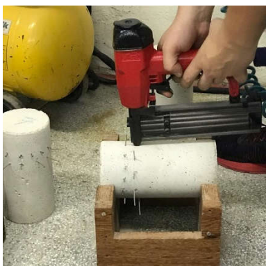
Figura 24 - Ensaio de cravação pneumática de pinos na argamassa
