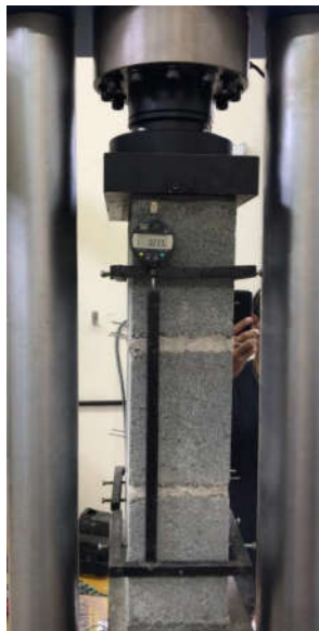
Figura 23 – Execução ensaio módulo de deformação do prisma
