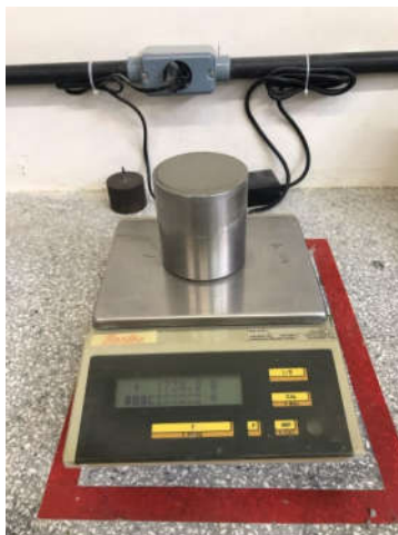
Figura 15 - Ensaio de densidade de massa da argamassa
