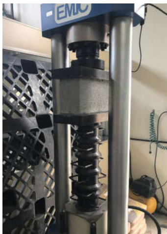
Figura 10 - Determinação da resistência à compressão
