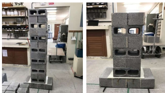
(c) Colocação de Carga
