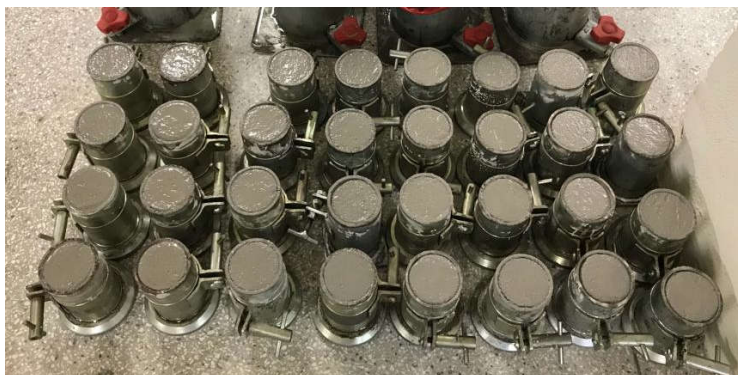
Figura 17 – Corpos de prova de argamassa 5x10cm
