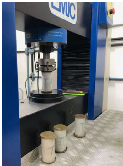
Figura 16 - Ensaio de resistência à compressão das argamassas
