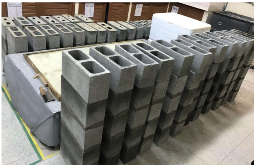
Figura 19 - Prismas para ensaios à tração na flexão e à compressão
