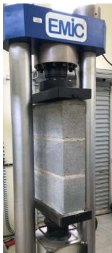
Figura 22 - Ensaio de resistência à compressão dos prismas
