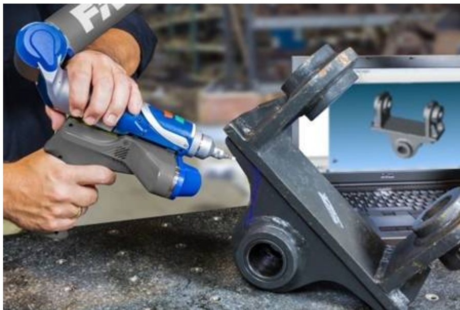
Figura 6 – Exemplo de aplicação de ER - Digitalização com braço articulado
