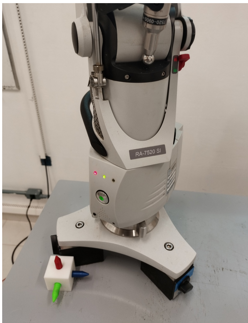
Figura 23 – Instalação do braço de medição na bancada
