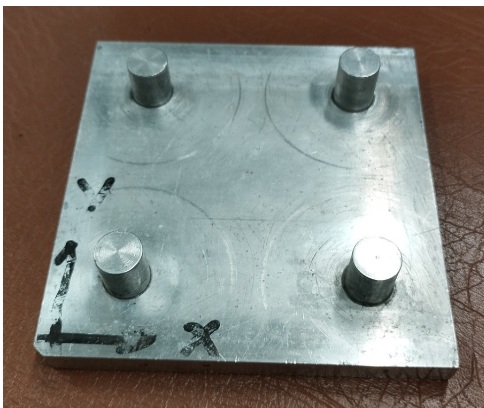
Figura 20 – Placa escolhida para corpo de prova
