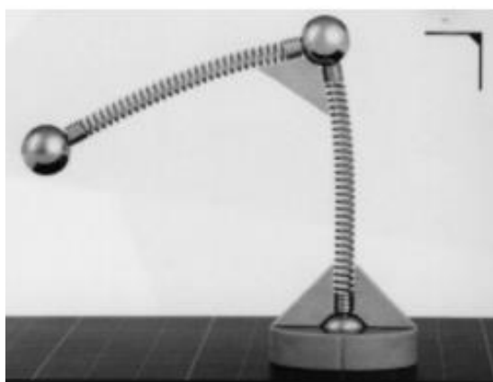
Figura 4 – Representação de uma ligação engastada
