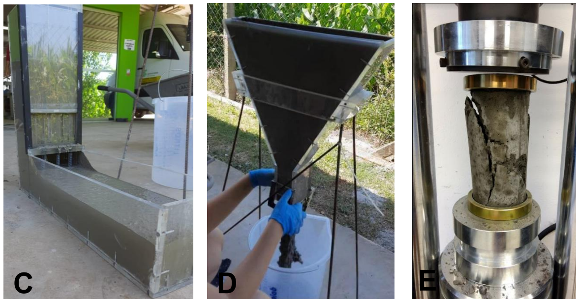
Figura 9 - Ensaio na fase concreto: C) Caixa L; D) Funil V; E) Resistência a compressão.
