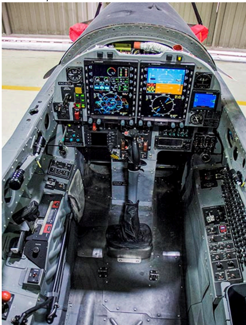
Figura 11 – Cockpit Embraer T-27 Tucano atualizado com Glass Cockpit .
