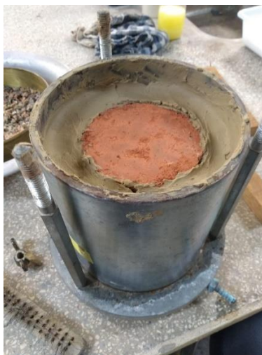
Figura 34: Corpo de prova posicionado no permeâmetro envolto com bentonita
