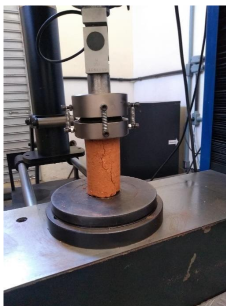
Figura 39: Corpo de prova posicionado na prensa
