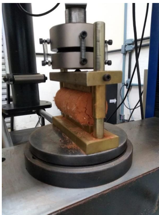
Figura 41: Corpo de prova posicionado na prensa
