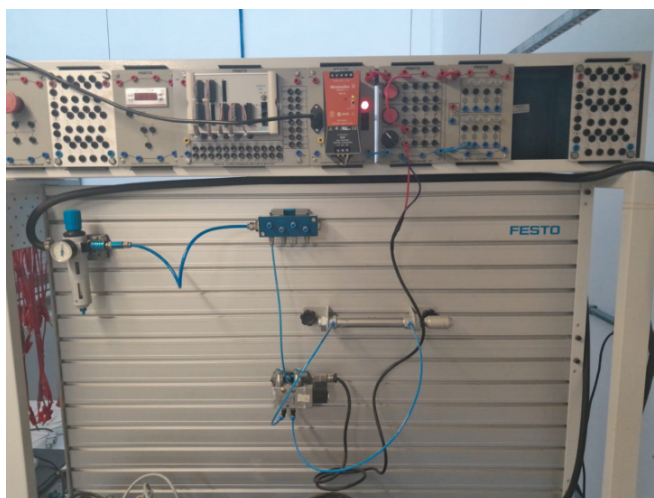
Figura 14 – Teste padrão da válvula eletropneumática em bancada
