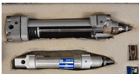
Figura 9 – Atuador - vista em corte
