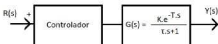
Figura 9 - Diagrama de blocos malha aberta
