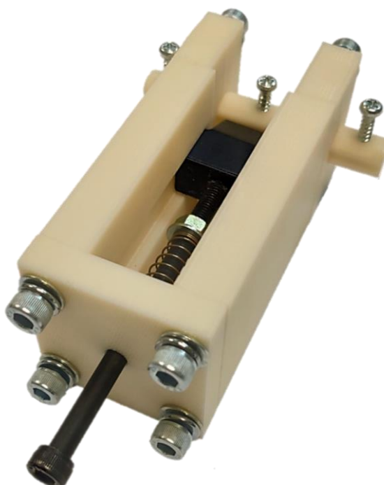
Figura 4-24 – Protótipo para teste de conceito do subconjunto eixo de retenção e elemento de restrição externa.
