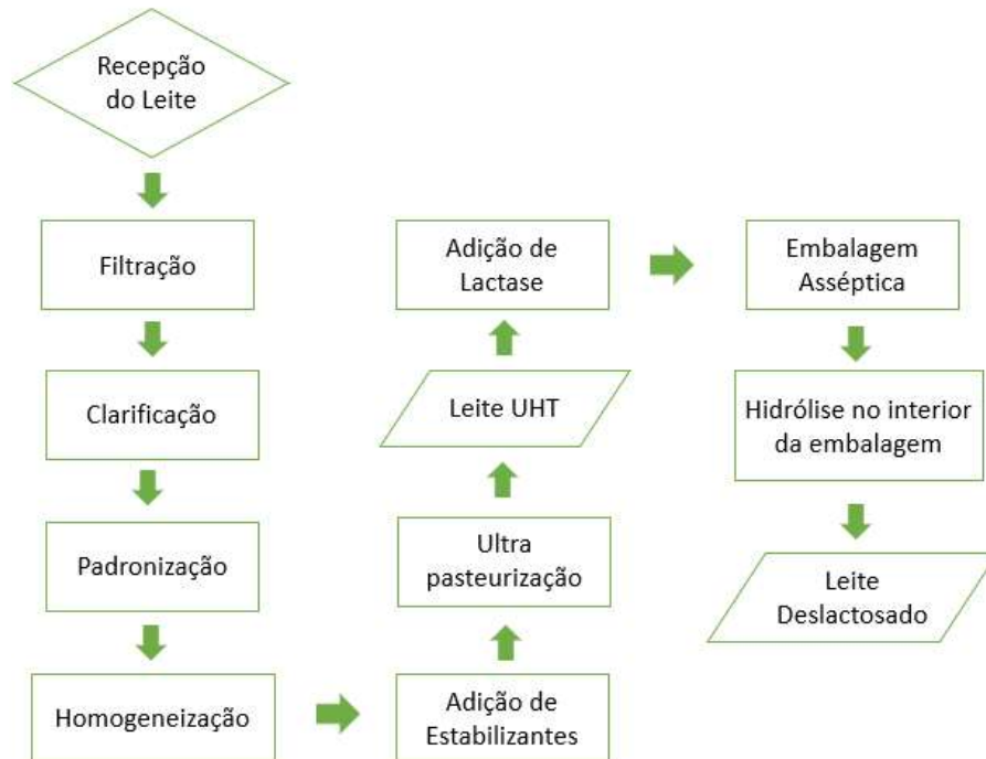
Figura 6. Fluxograma do leite Zero Lactose - adição da enzima no envase.
