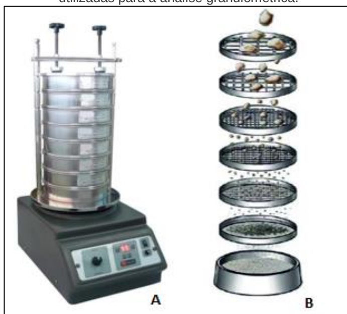
Figura 11 - (A) agitador de peneiras e (B) peneiras utilizadas para a análise granulométrica.
