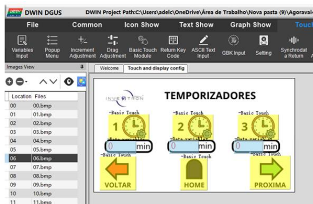
Fig. 10. Interface gráfica para configuração de temporizadores no sistema HMI DWIN.
