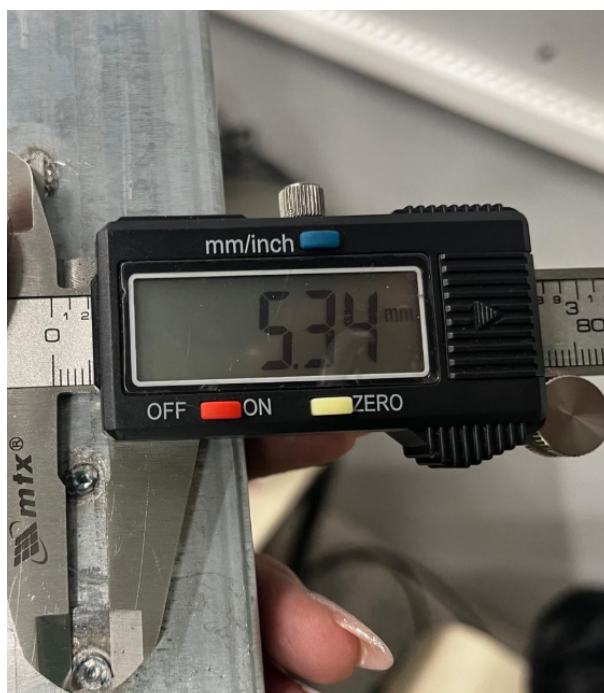
Figura 7 – Diâmetro do núcleo de uma solda ponto como critério de qualidade.
