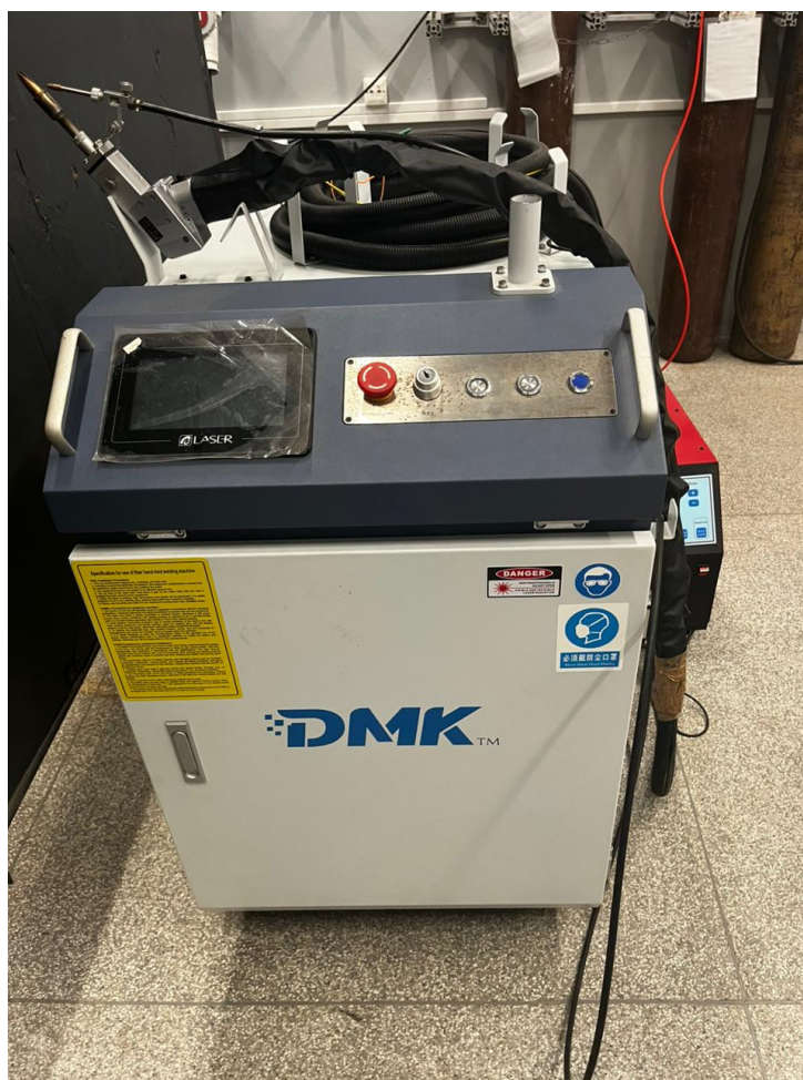
Figura 8 – Fonte de soldagem laser por fibra óptica modelo Qilin BWT16.
