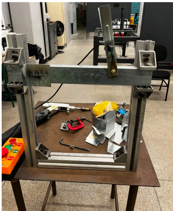
Figura 16 – Gabarito construído em alumínio de 450x380x90mm para fixação dos corpos de prova na posição horizontal de soldagem..
