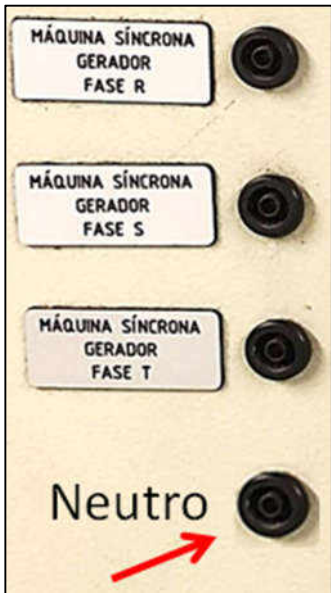
Figura 23 - Ponto de conexão ao neutro da máquina síncrona
