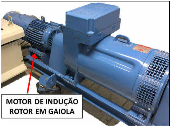
Figura 6 - Acoplamento entre a máquina síncrona e o motor de indução com rotor gaiola de esquilo
