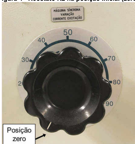
Figura 4 - Reostato R2 na posição inicial (zero).
