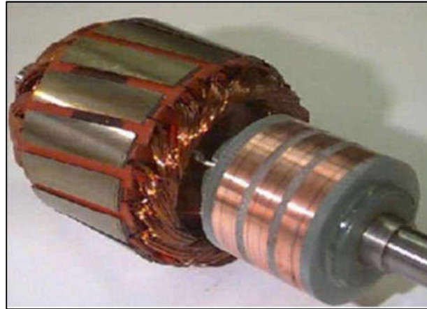
Figura 2 - Típico rotor bobinado, de anéis
