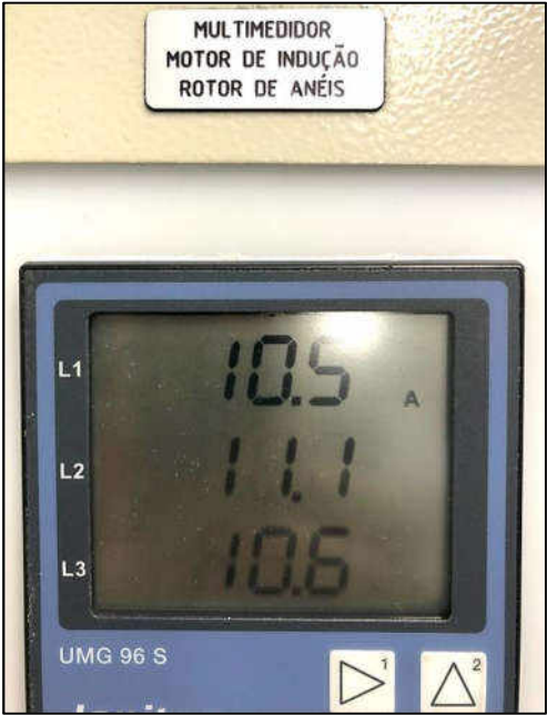
Figura 36 - Corrente do motor M2 com rotor travado
