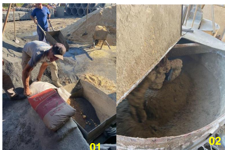
Figura 4 – Controle de quantidades dos insumos de cada formulação (01) e produção da massa no misturador (02).
