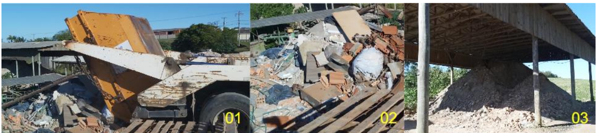
Figura 2 – Material recebido na usina de reciclagem sem triagem (01), material preparado para processo de separação (02) e galpão na usina de reciclagem com RCC Classe A armazenado para o processo de britagem (03).
