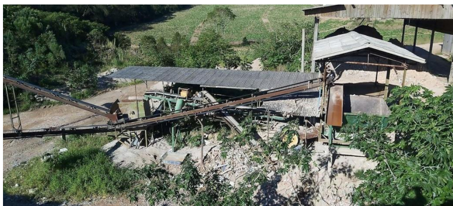
Figura 3 – Britador de mandíbulas utilizado na produção de agregado reciclado de RCC.
