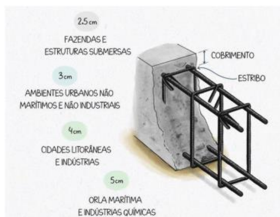
Figura 5 - Cobrimento das Armaduras
