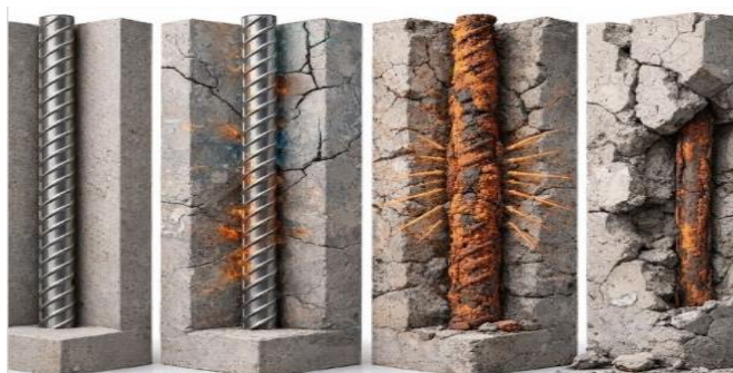
Figura 11 - Representação do processo de corrosão das armaduras em concreto armado
