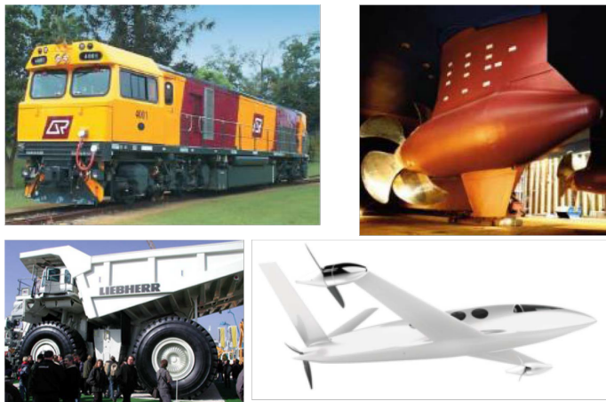
Fig. 1. Locomotiva Diesel-Elétrica, Navio com Sistema Azipod®, Veículo de Mineração Liebherr T282 B e Aeronave Eviation Alice. Adaptado de [5]
