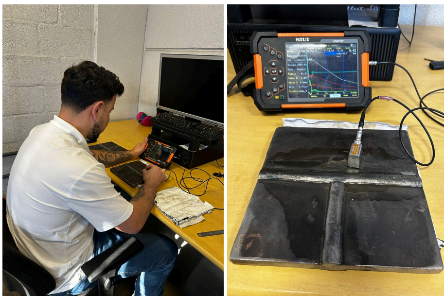
Figura 13 - Ensaio de Ultrassom
