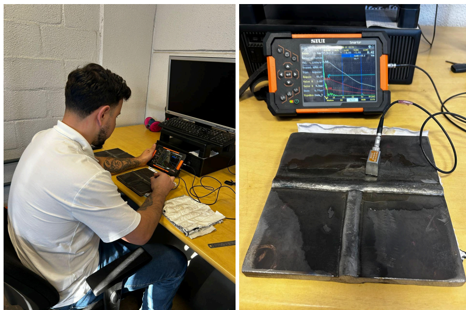
Figura 23 - Ensaio de Ultrassom
