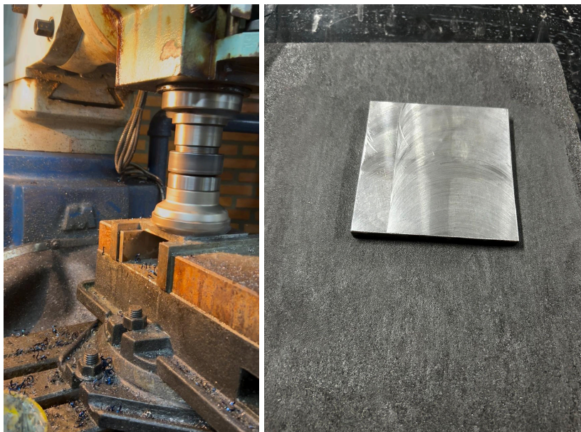
Figura 14 - Usinagem dos corpos de prova
