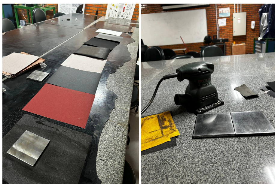
Figura 15 - Lixamento dos corpos de prova
