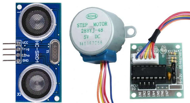
Figura 24 – Sensor de Distância Ultrassônico (HC-SR04) e Motor de Passo (28BYJ-48 5VDC)
