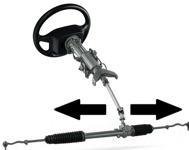
Figura 6 – Sistema de Direção Pinhão Cremalheira
