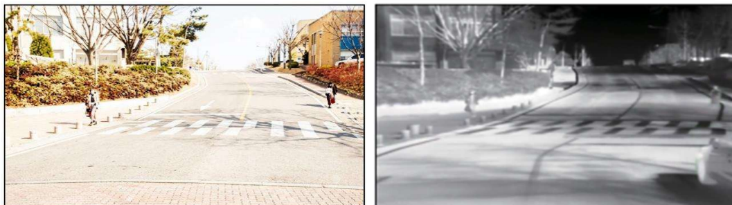
Figura 12 - Câmera Comum (RGB) comparado com Câmera Térmica durante o dia
