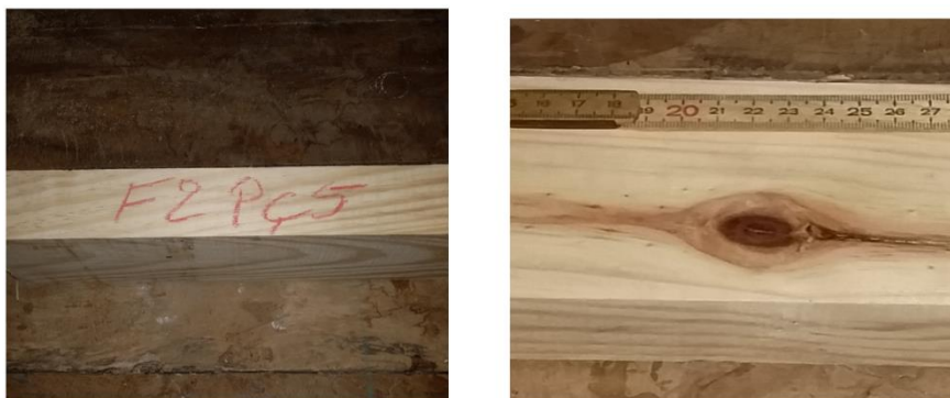
Figura 6 - Inspeção visual de peça de madeira
