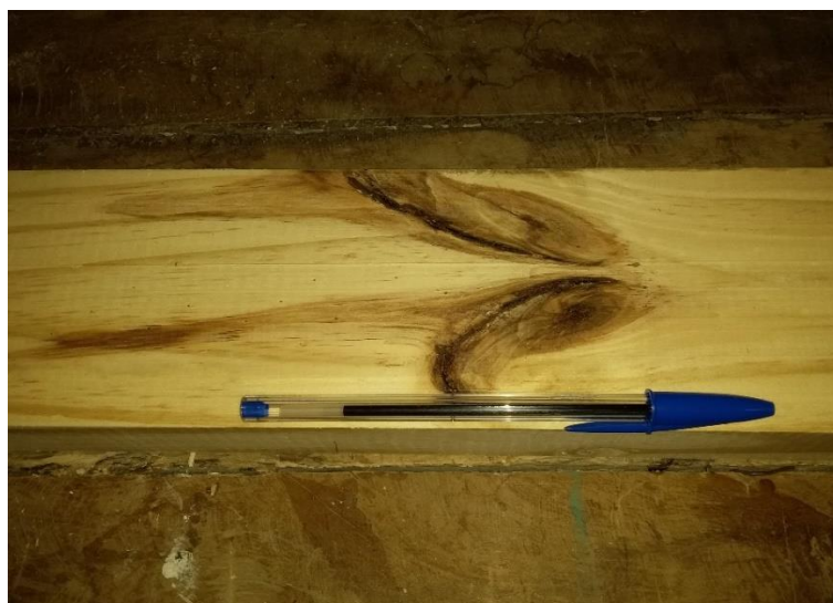
Figura 11 - Nó Firme de grande dimensão em relação à largura da peça
