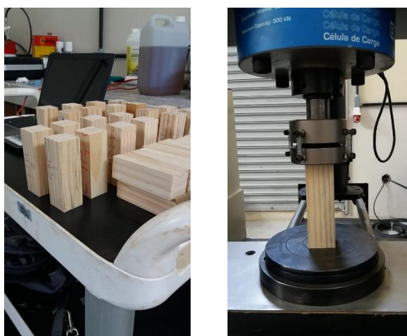
Figura 9 - Corpos de prova usados no ensaio de compressão paralela às fibras
