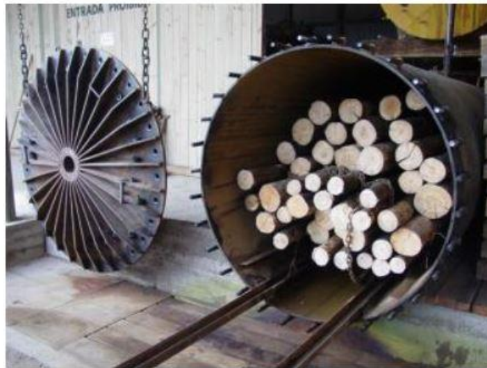
Figura 4 - Autoclave para tratamento de madeira
