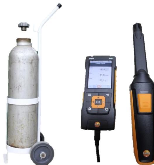
Figura 9 - Equipamentos para medição da renovação do ar
