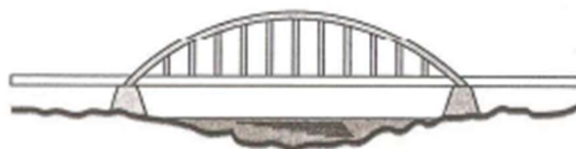
Figura 3 – Ponte em arco superior
