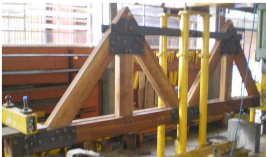
Figura 19 – Treliça formada por módulos de madeira
