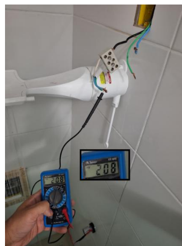
Imagem 52 – Cenário 2 (parte 2) PEN rompido \leftrightarrow R_f e R_t sem carga.
