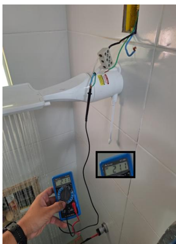
Imagem 52 – Cenário 2 (parte 2) PEN rompido \leftrightarrow R_f e R_t sem carga.
