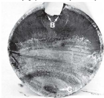
Figura 3 - Propagação de trinca por falha por fadiga.
