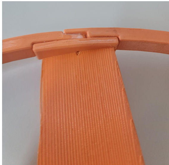
Figura 51: Aro com defeito de impressão.
