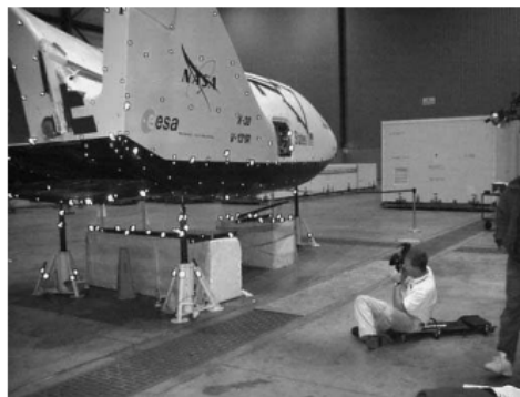
Figura 8 - Medição por fotogrametria na NASA.
