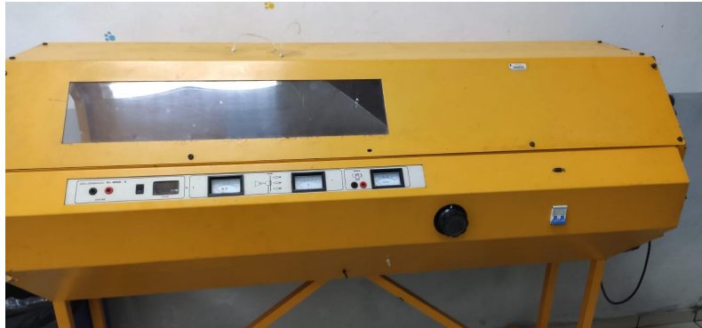
Figura 46: Túnel aerodinâmico DL WIND-B utilizado no projeto.
