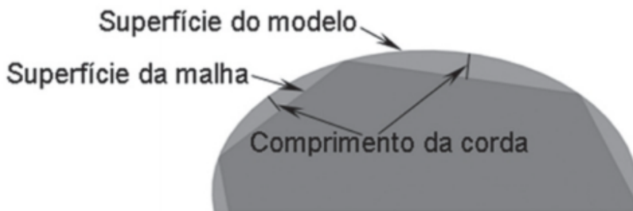
Figura 13 - Definição do comprimento de corda.
