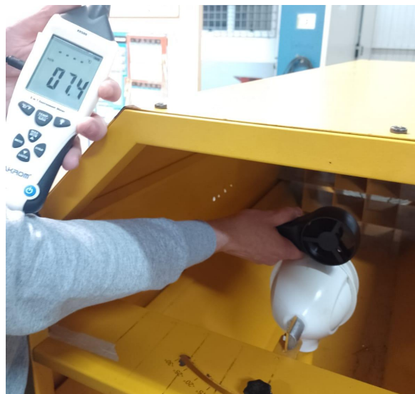
Figura 47: Medição da velocidade do ar no ponto de fixação das hélices no gerador.
