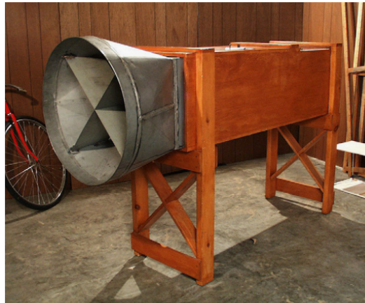
Figura 17: Túnel de vento dos irmãos Wright em 1901.
