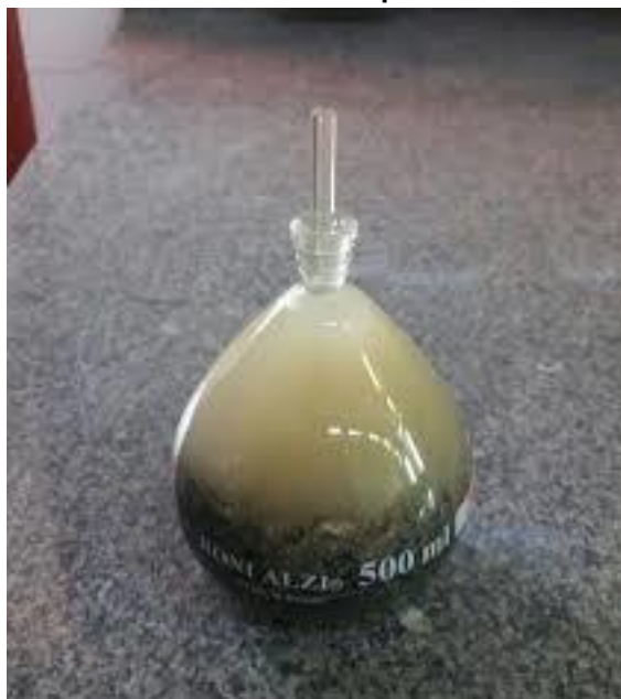
Figura 2.4 – Ensaio de massa específica do solo
