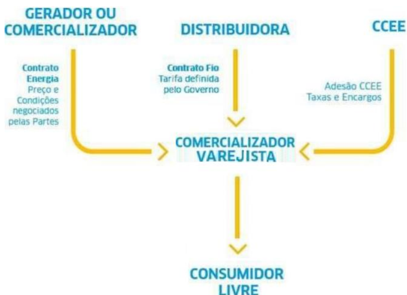
Figura 21 – Esquema de relações no ACL - modelo varejista (adaptado de: ALMEIDA, 2018)
