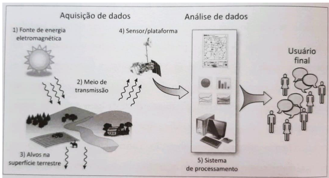
Figura 6: Componentes básicos do sistema de informações por sensoriamento remoto
