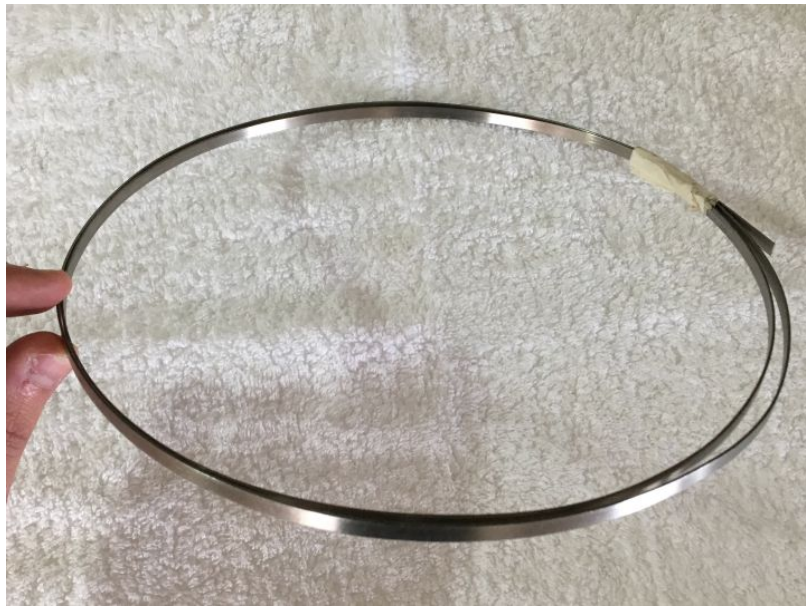
Figura 16 - Elemento resistivo tipo fita níquel cromo
