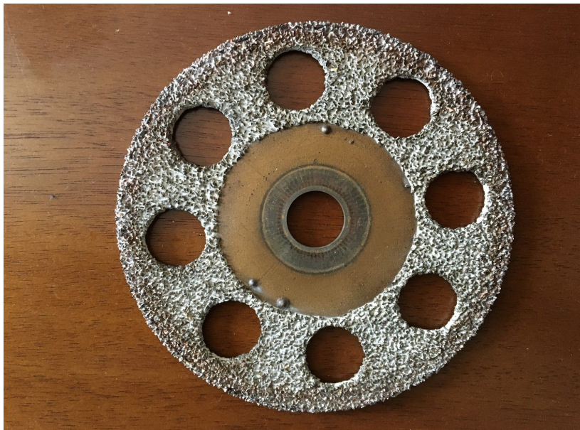
Figura 9 - Disco de corte abrasivo da SRS Surfboards
